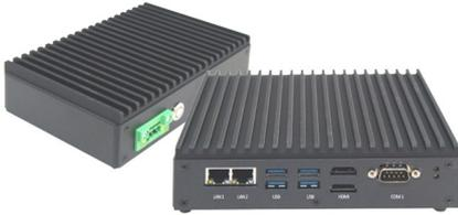
Sehr kleine - Platz sparende - Ausführung, nur 170mm x 115mm. **Höhe nur 49mm.** CPU Bord mit **Intel Celeron J6412 & N97**. Mit Gummi-FüÙe an der Unterseite oder VESA – oder Hutschienenmontage. Spannungsversorgung 12VDC und 24VDC. Optionale Erweiterung **Wifi** und **Bluetooth**.
