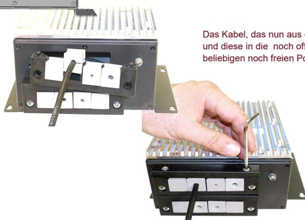
Das Kabel, das nun aus der Öffnung ragt wird in die passende Tülle eingeklemmt und diese in die noch offene Kabeldurchführung an einer beliebigen noch freien Position eingeschoben.
